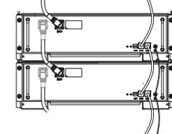
Schritt 2 : Spannungswert messen: Nachdem alle Batteriemodule in Reihe geschaltet sind, verwenden Sie ein Multimeter, um die Gleichspannung an der Gleichstromklemme zu messen. Die Gesamtspannung sollte N \*52±10V betragen (N ist die Gesamtzahl der Batteriemodule). Bitte beachten Sie die Abbildung unten für die Spannungsprüfung.
