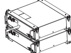
Hinweis: Max. 4 Stück Batterien pro Stapel. Bitte stellen Sie sicher, dass jedes System 1 BMS BOX enthält.
