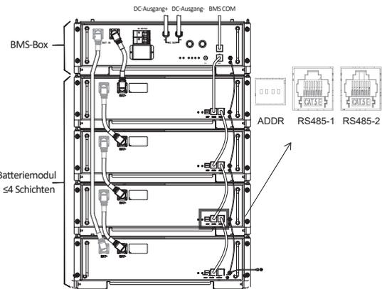
Erdungskabel: Schließen Sie das Erdungskabel an, um sicherzustellen, dass alle Batterien geerdet sind. Die Verdrahtung muss in der unten gezeigten Reihenfolge angeschlossen werden.
