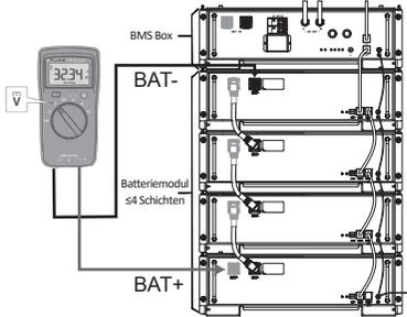
Anschluss der Kommunikationskabel: Schritt 1: Nehmen Sie das positive Hauptkabel (zwei orangefarbene Stecker) und die negative Hauptleitung (zwei schwarze Stecker), um die BMS BOX anzuschließen.
