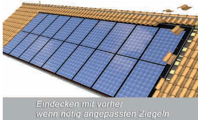
Es ist möglich, dass die Ziegelreihen an den Modulfeldrändern zugeschnitten werden müssen, um eine ordentliche und normgerechte Eindeckung zu gewährleisten. Bitte sicherstellen, dass alle Dacheindeckungselemente nach Vorschrift mechanisch befestigt werden.
